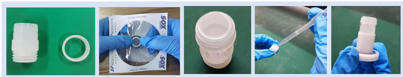
采用装有硅胶阀的液体专用样品杯及卡环
