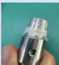
使用工装辅助卡环将测试膜覆盖在样 品杯上
