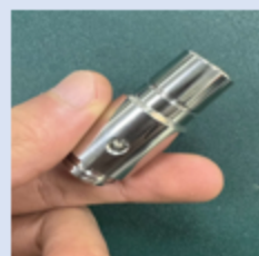
采用不锈钢样品杯 侧方预留排气口
