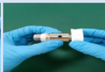
将富集头安装在样品杯底座 上机测试样
