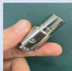
采用不锈钢样品杯 侧方预留排气口
