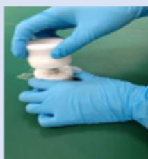
使用工装辅助卡环将测试膜要盖在样 品杯上
