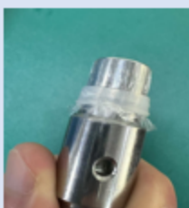
使用工装辅助卡环将测试膜要盖在样 品杯上
