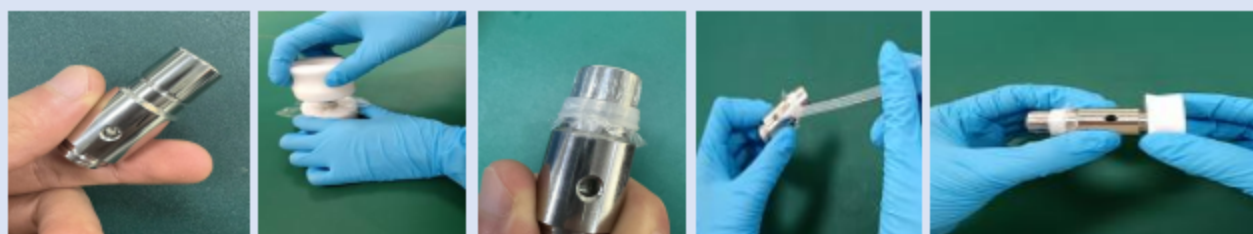
采用不锈钢样品杯 侧方预留排气口
